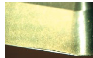
トータル(90分)加工後の刃先の損傷状態 Cutting edge after 90 minutes of milling
