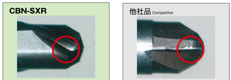
加工後の刃先状態 Cutting edge condition after machining
