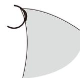
カールした強固な切りくずがすくい面を激しくこすり摩耗を進行させる。
