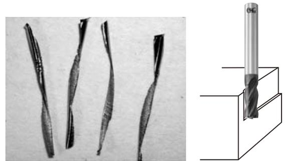
図 2.1.7 エンドミル側面切削での流れ形切りくず
